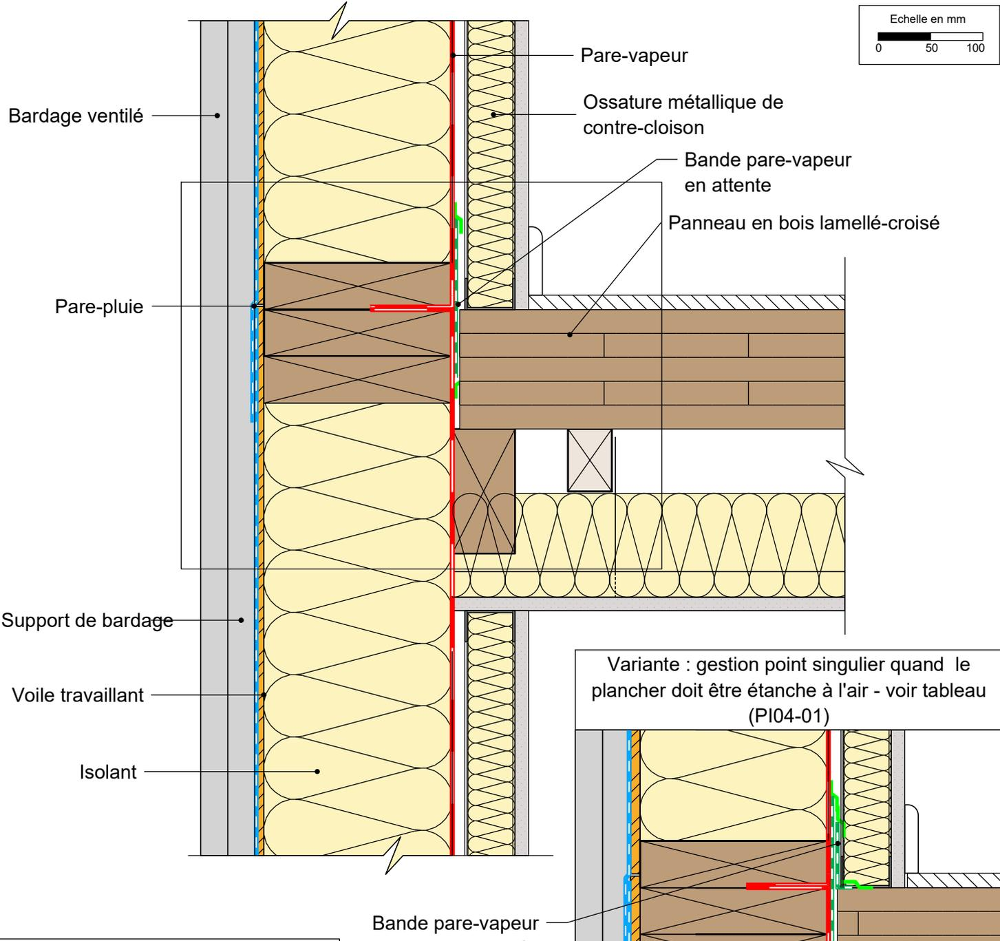
Variante : gestion point singulier quand le plancher doit être étanche à l'air - voir tableau (PI04-01)
