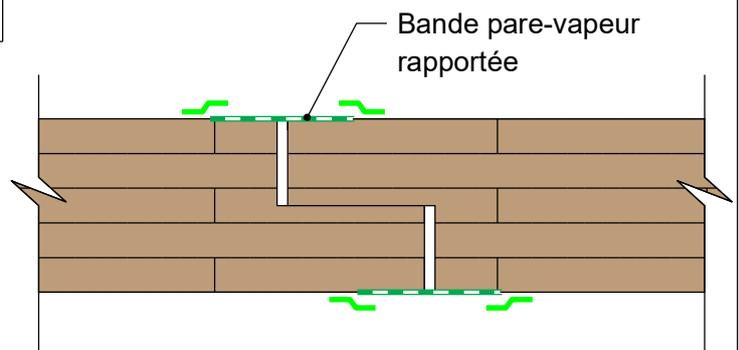
Exemple 2 : Cas d'un assemblage par languette
