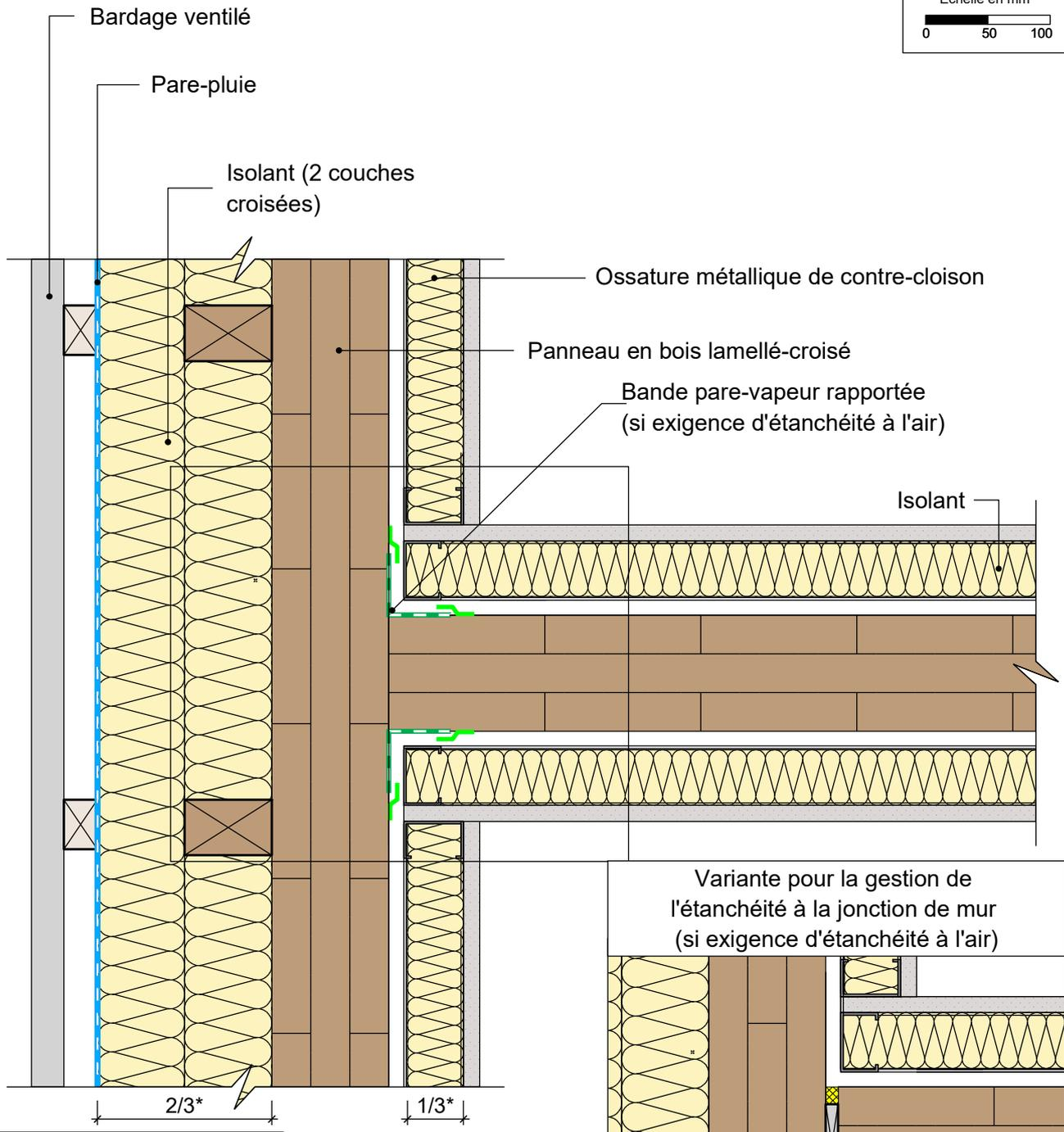
Variante pour la gestion de l'étanchéité à la jonction de mur (si exigence d'étanchéité à l'air)
