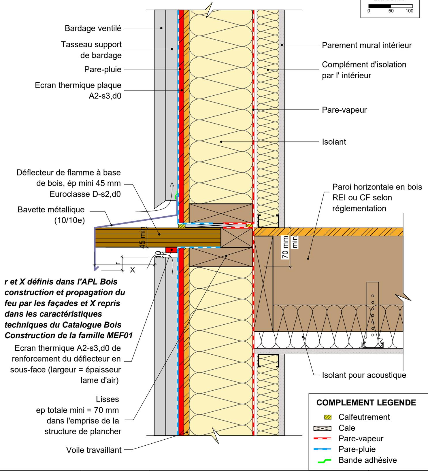
*r* et *X* définis dans l'APL Bois construction et propagation du feu par les façades et *X* repris dans les caractéristiques techniques du Catalogue Bois Construction de la famille MEF01
