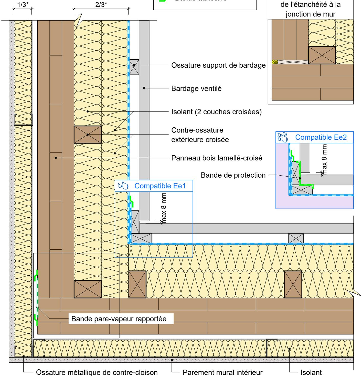
Variante pour la gestion de l'étanchéité à la jonction de mur
