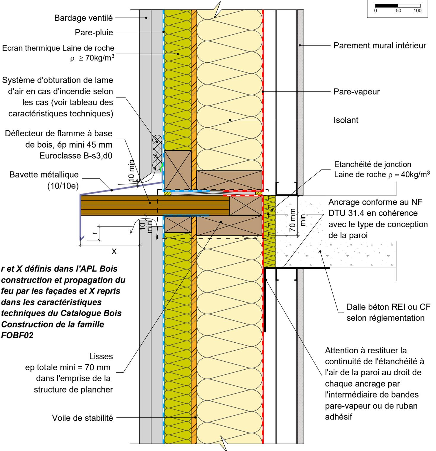
*r et X définis dans l'APL Bois construction et propagation du feu par les façades et X repris dans les caractéristiques techniques du Catalogue Bois Construction de la famille FOBF02*
