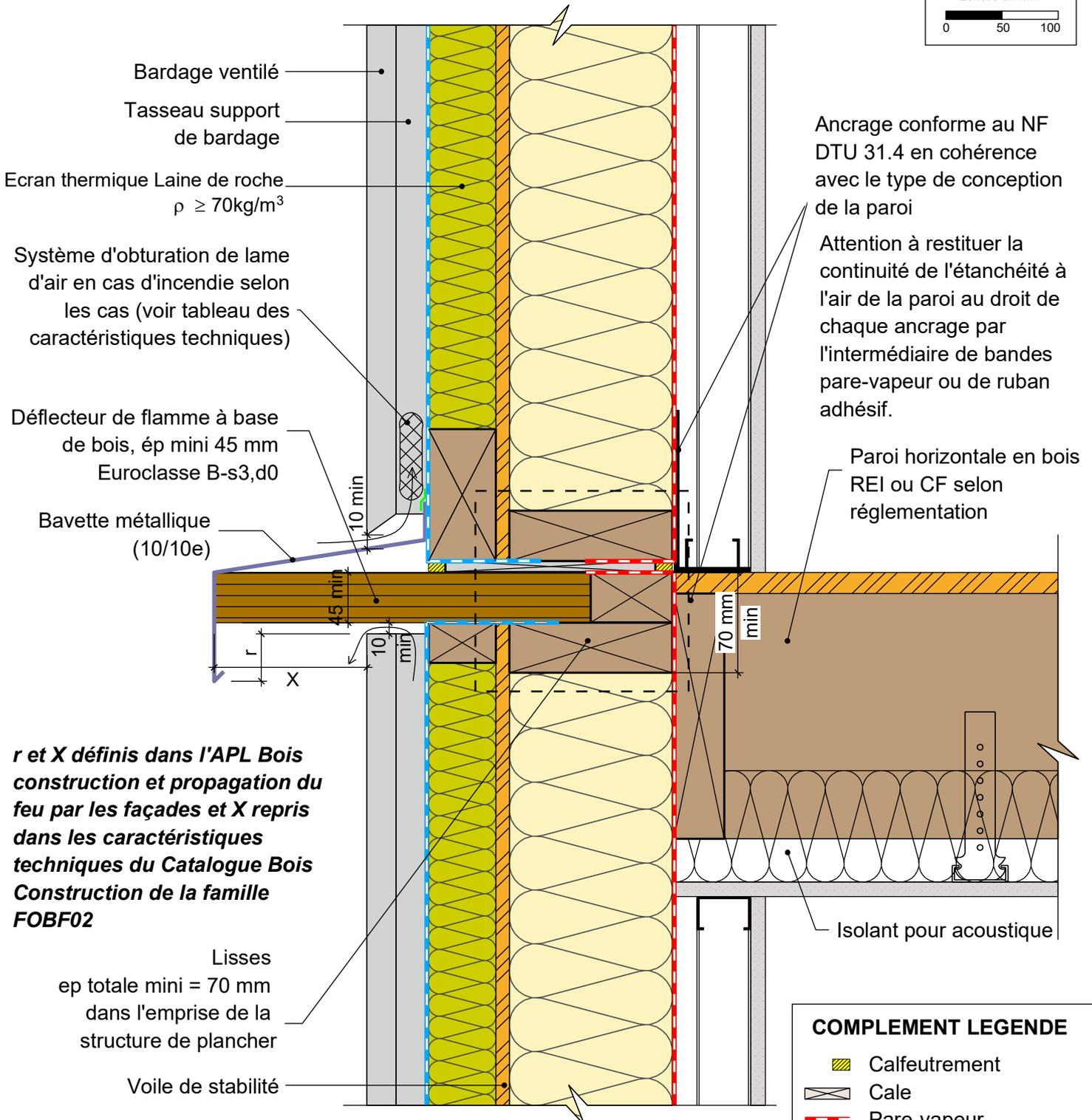
Ancrage conforme au NF DTU 31.4 en cohérence avec le type de conception de la paroi
