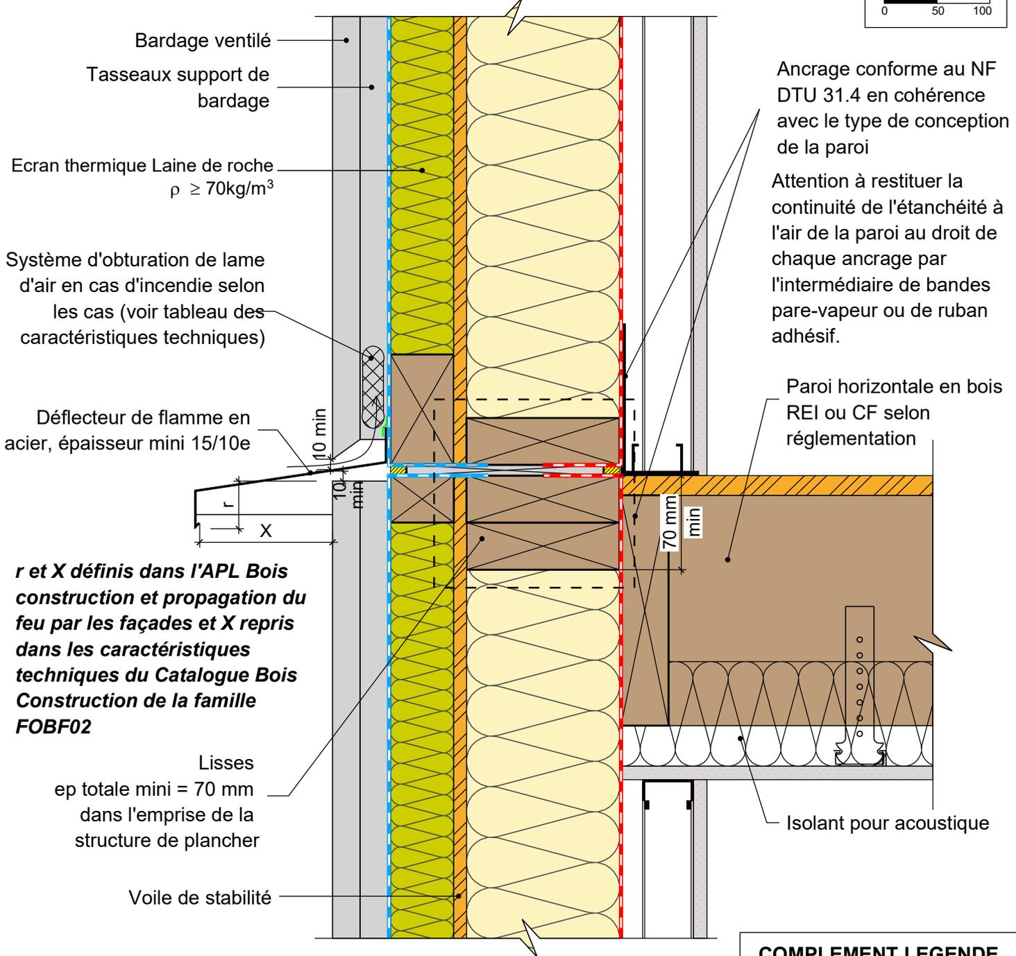
Ancrage conforme au NF DTU 31.4 en cohérence avec le type de conception de la paroi
