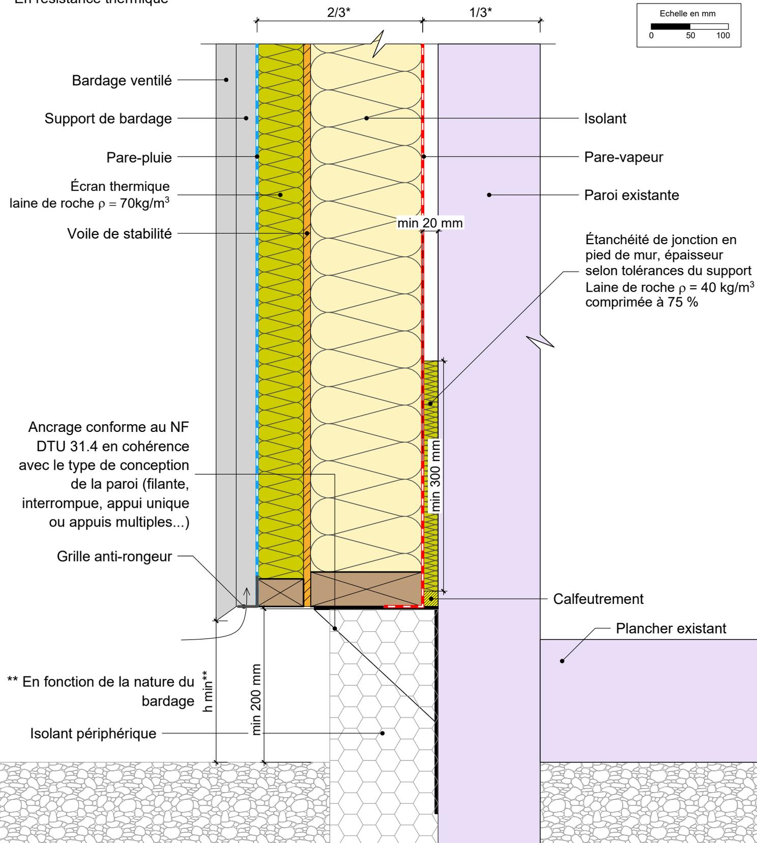
Ancrage conforme au NF DTU 31.4 en cohérence avec le type de conception de la paroi (filante, interrompue, appui unique ou appuis multiples...)
