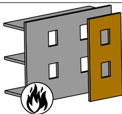
\* La mise en œuvre d'un écran thermique CTBX ignifugé ne permet d'atteindre qu'une stabilité au feu R60 et offre un choix assez limité de bardage.
