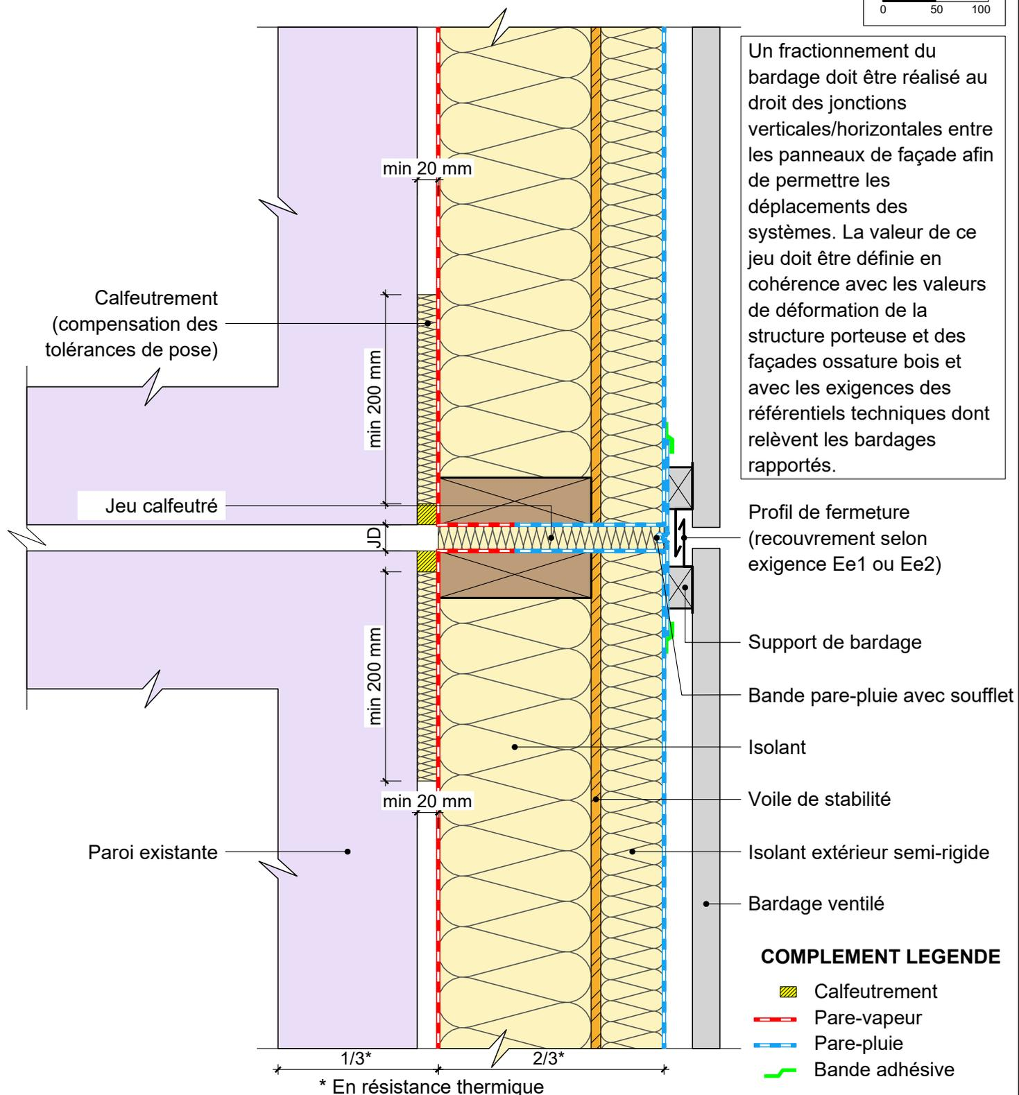
Un fractionnement du bardage doit être réalisé au droit des jonctions verticales/horizontales entre les panneaux de façade afin de permettre les déplacements des systèmes. La valeur de ce jeu doit être définie en cohérence avec les valeurs de déformation de la structure porteuse et des façades ossature bois et avec les exigences des référentiels techniques dont relèvent les bardages rapportés.
