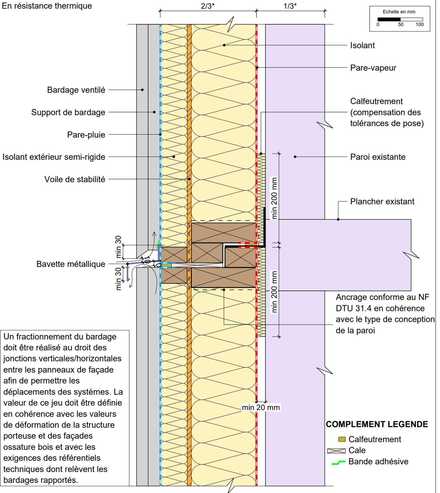
Un fractionnement du bardage doit être réalisé au droit des jonctions verticales/horizontales entre les panneaux de façade afin de permettre les déplacements des systèmes. La valeur de ce jeu doit être définie en cohérence avec les valeurs de déformation de la structure porteuse et des façades ossature bois et avec les exigences des référentiels techniques dont relèvent les bardages rapportés.
