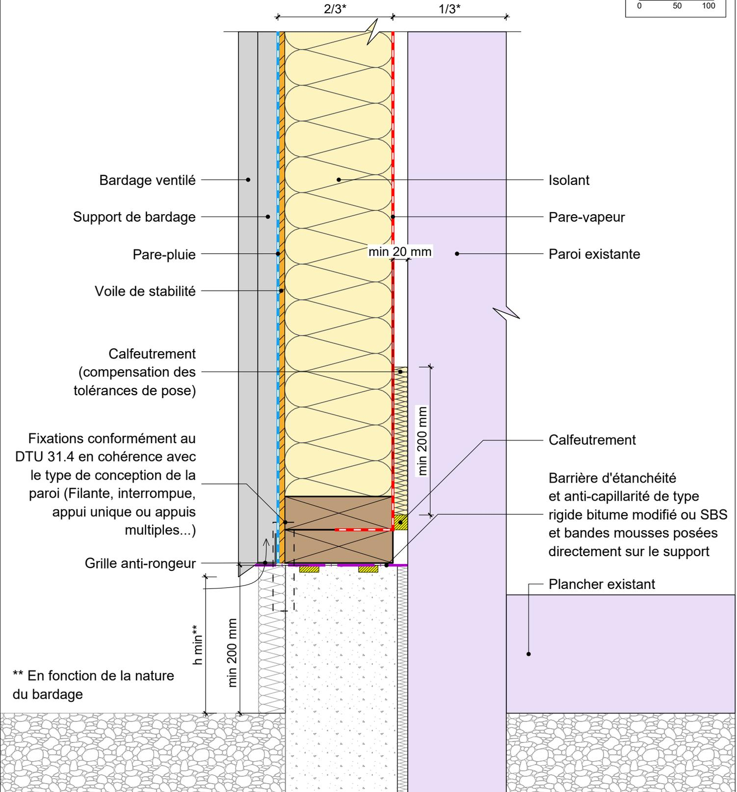
Fixations conformément au DTU 31.4 en cohérence avec le type de conception de la paroi (Filante, interrompue, appui unique ou appuis multiples...)
