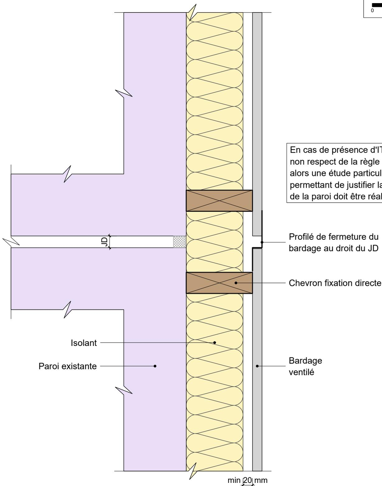
En cas de présence d'ITI et de non respect de la règle 2/3 - 1/3 alors une étude particulière permettant de justifier la salubrité de la paroi doit être réalisée.
