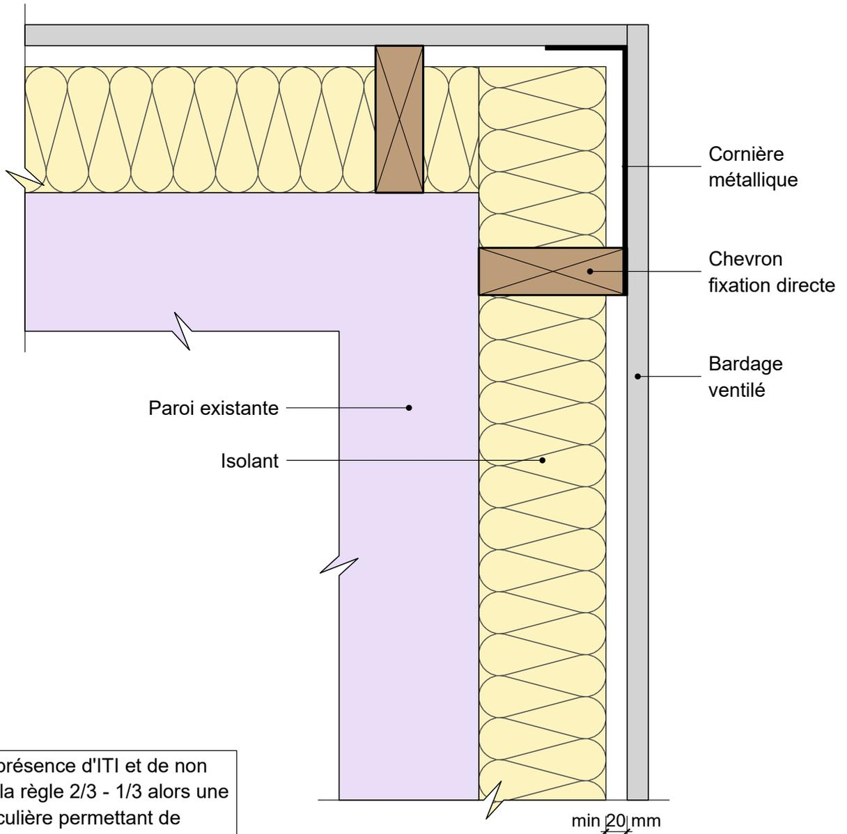
En cas de présence d'ITI et de non respect de la règle 2/3 - 1/3 alors une étude particulière permettant de justifier la salubrité de la paroi doit être réalisée.
