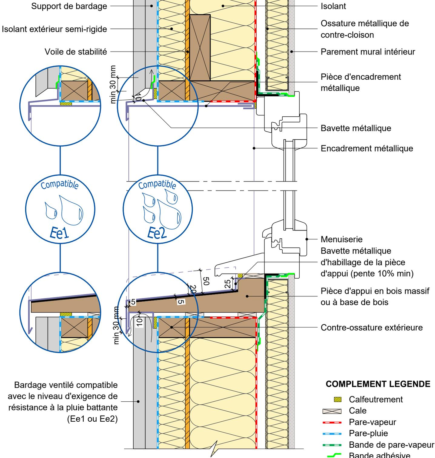
Bardage ventilé compatible avec le niveau d'exigence de résistance à la pluie battante (Ee1 ou Ee2)
