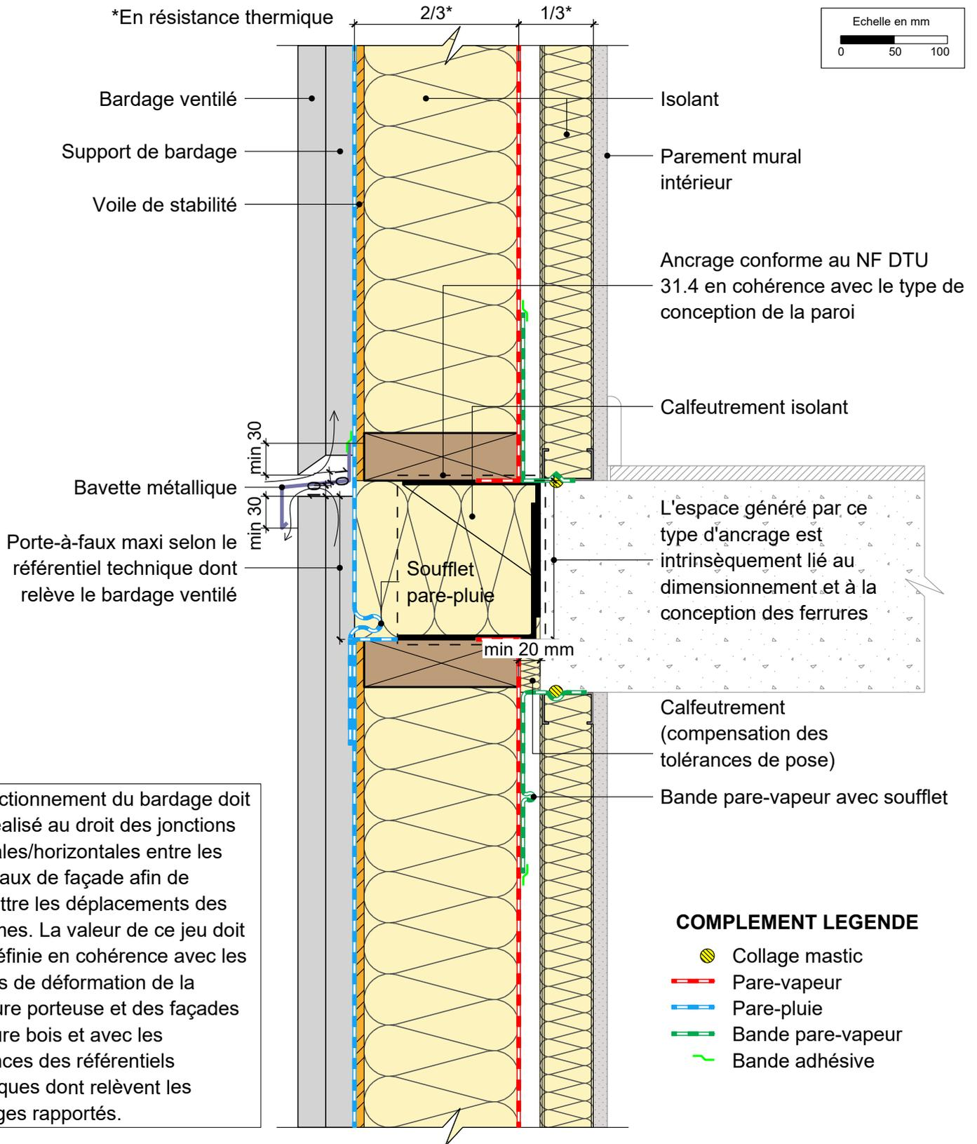
Un fractionnement du bardage doit être réalisé au droit des jonctions verticales/horizontales entre les panneaux de façade afin de permettre les déplacements des systèmes. La valeur de ce jeu doit être définie en cohérence avec les valeurs de déformation de la structure porteuse et des façades ossature bois et avec les exigences des référentiels techniques dont relèvent les bardages rapportés.
