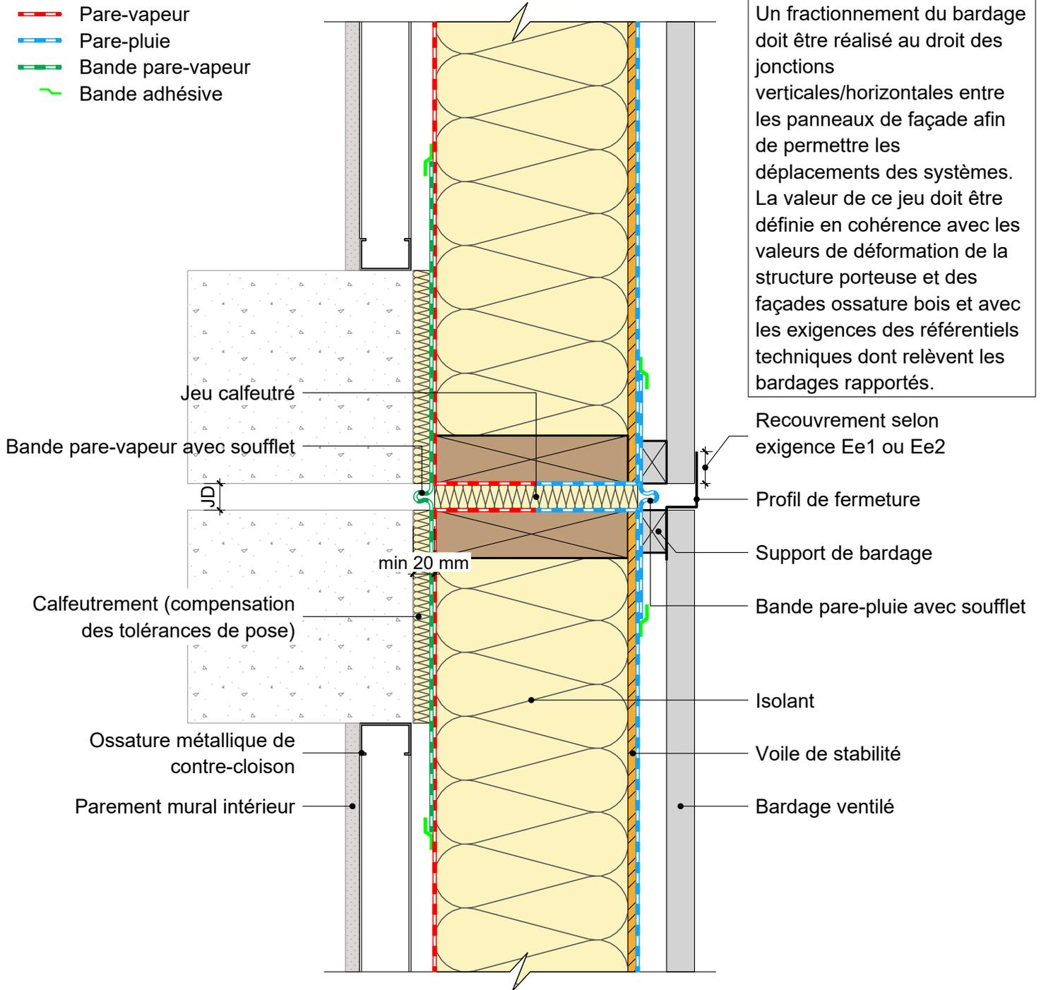
Un fractionnement du bardage doit être réalisé au droit des jonctions verticales/horizontales entre les panneaux de façade afin de permettre les déplacements des systèmes. La valeur de ce jeu doit être définie en cohérence avec les valeurs de déformation de la structure porteuse et des façades ossature bois et avec les exigences des référentiels techniques dont relèvent les bardages rapportés.
