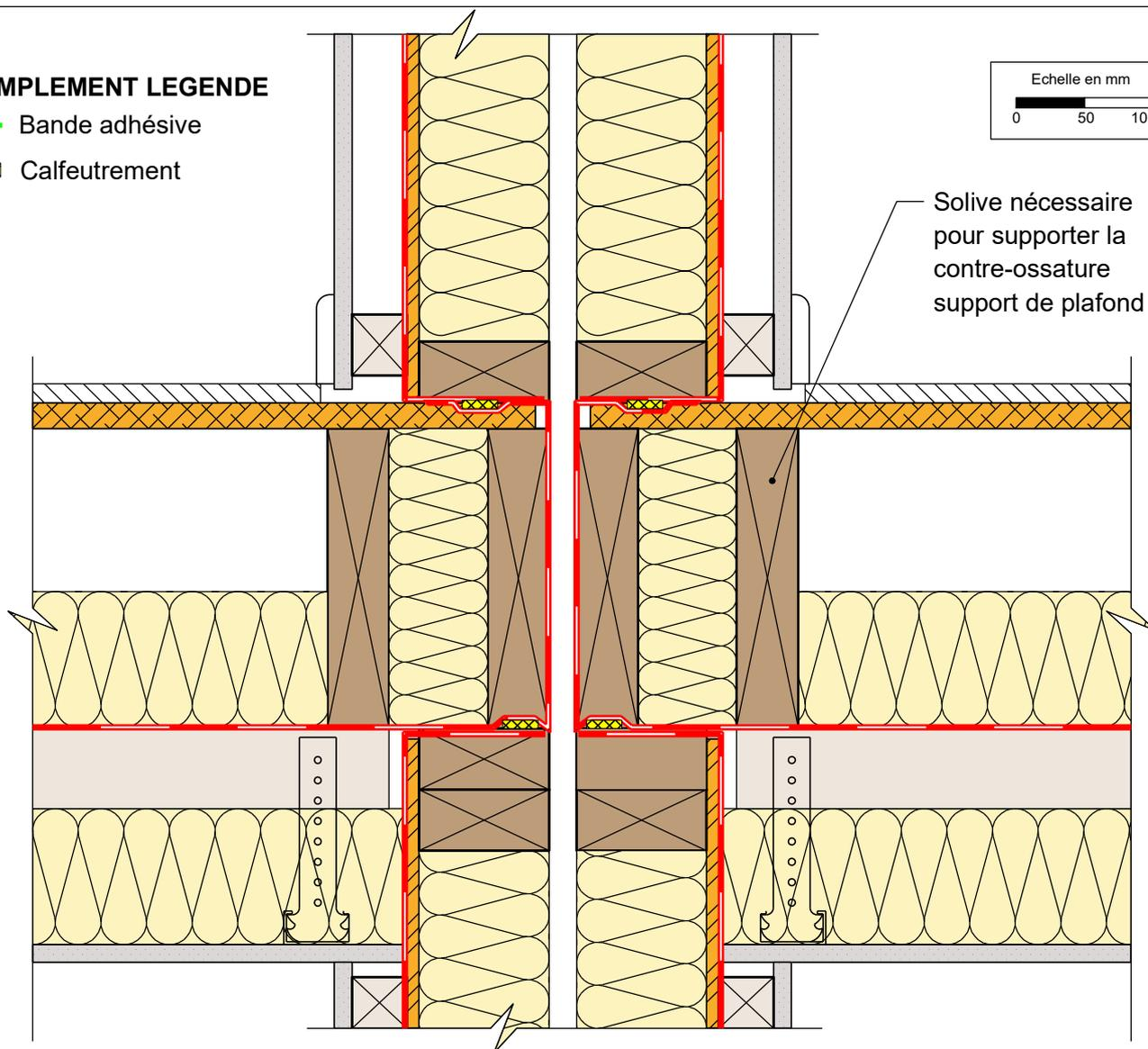
NOTA: Si absence de mur porteur intérieur à l'étage inférieur les charges doivent être reprises par le plancher lui-même ou tout autre dispositif de renforcement (poteau, poutre, portique,...)
