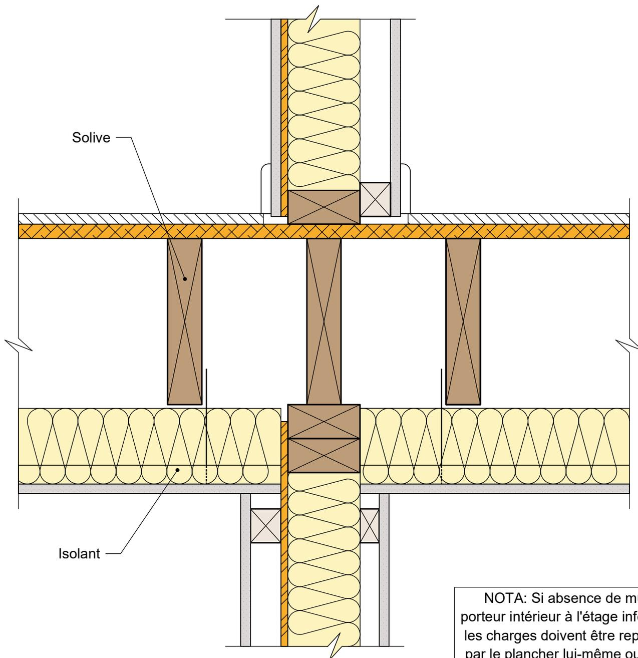
NOTA: Si absence de mur porteur intérieur à l'étage inférieur les charges doivent être reprises par le plancher lui-même ou tout autre dispositif de renforcement (poteau, poutre, portique,...)
