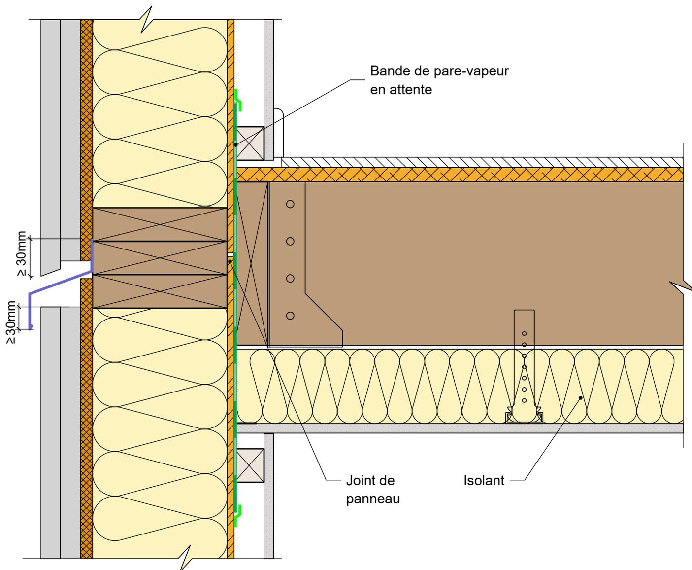
**MUR EXTERIEUR TYPE 10: Isolant en âme - voile travaillant intérieur sans film pare-vapeur**
