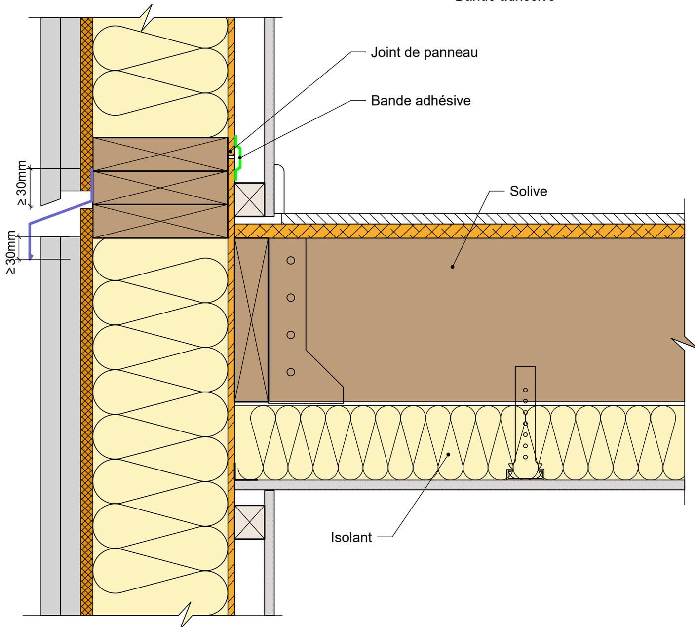
**MUR EXTERIEUR TYPE 10: Isolant en âme - voile travaillant intérieur sans film pare-vapeur**
