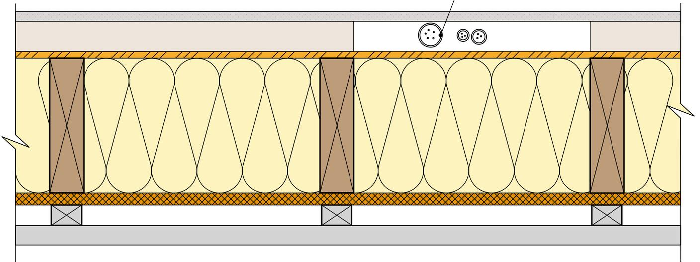
**MUR EXTERIEUR TYPE 10: Isolant en âme - voile travaillant intérieur sans film pare-vapeur**
