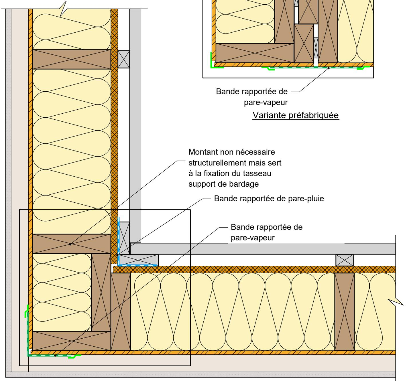
**MUR EXTERIEUR TYPE 10: Isolant en âme - voile travaillant intérieur sans film pare-vapeur**
