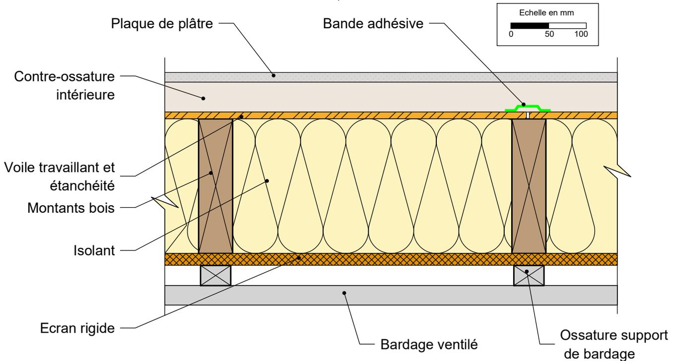
**MUR EXTERIEUR TYPE 10: Isolant en âme - voile travaillant intérieur sans film pare-vapeur**
