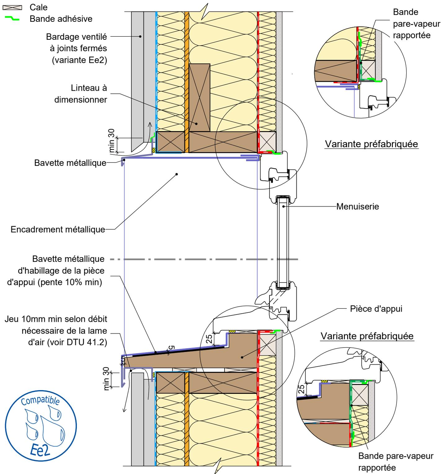
**MUR EXTERIEUR TYPE 8: Isolant en âme et en doublage intérieur et extérieur**
