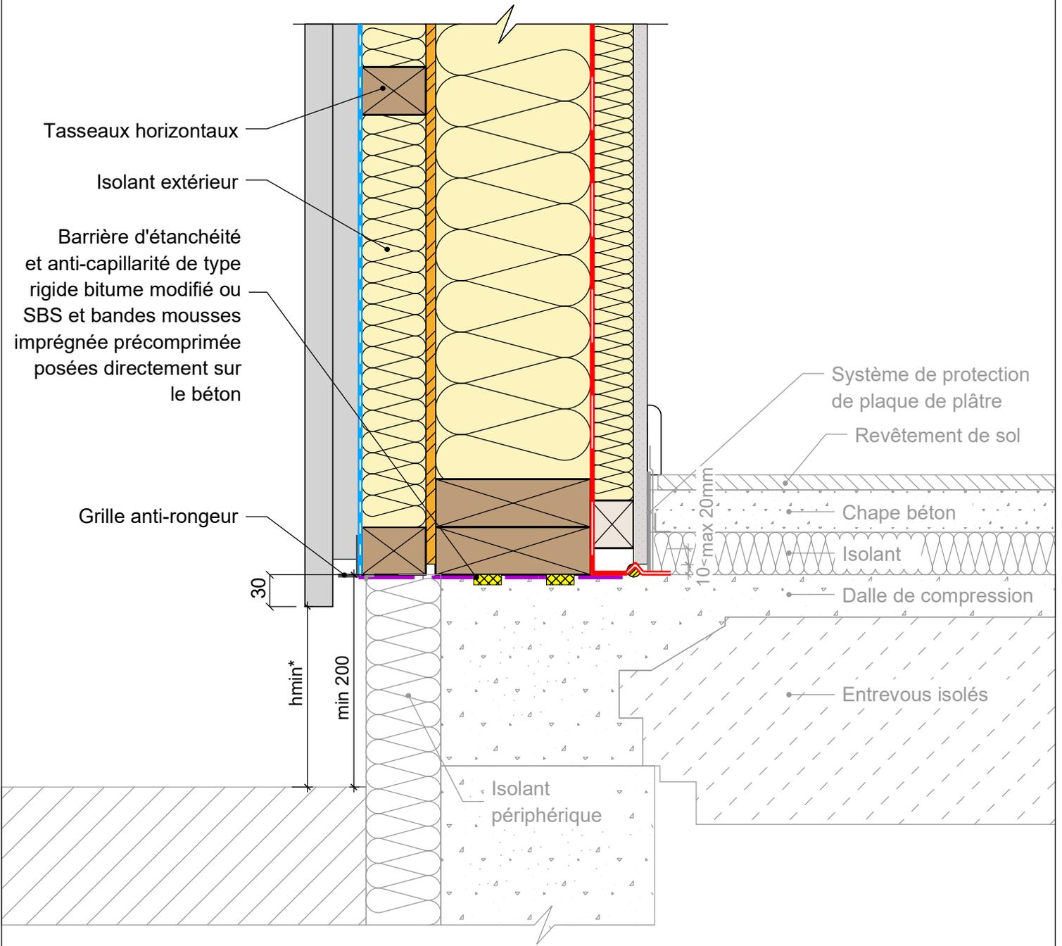
**MUR EXTERIEUR TYPE 8: Isolant en âme et en doublage intérieur et extérieur**
