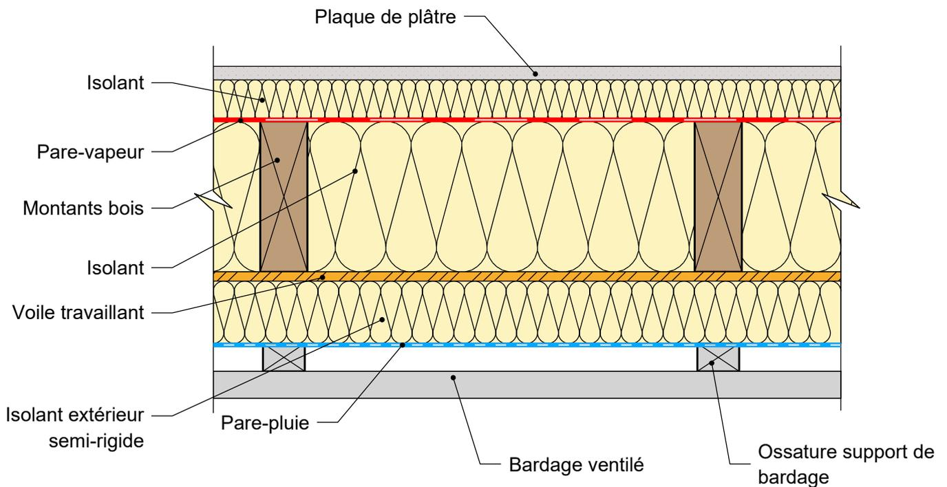
**MUR EXTERIEUR TYPE 8: Isolant en âme et en doublage intérieur et extérieur**
