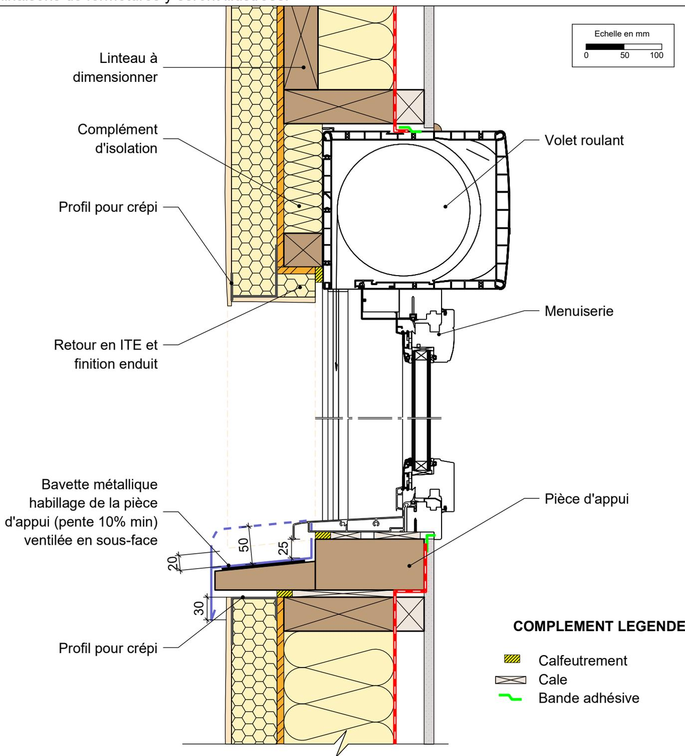
**MUR EXTERIEUR TYPE 7: Isolant en âme et ITE avec finition enduit**
