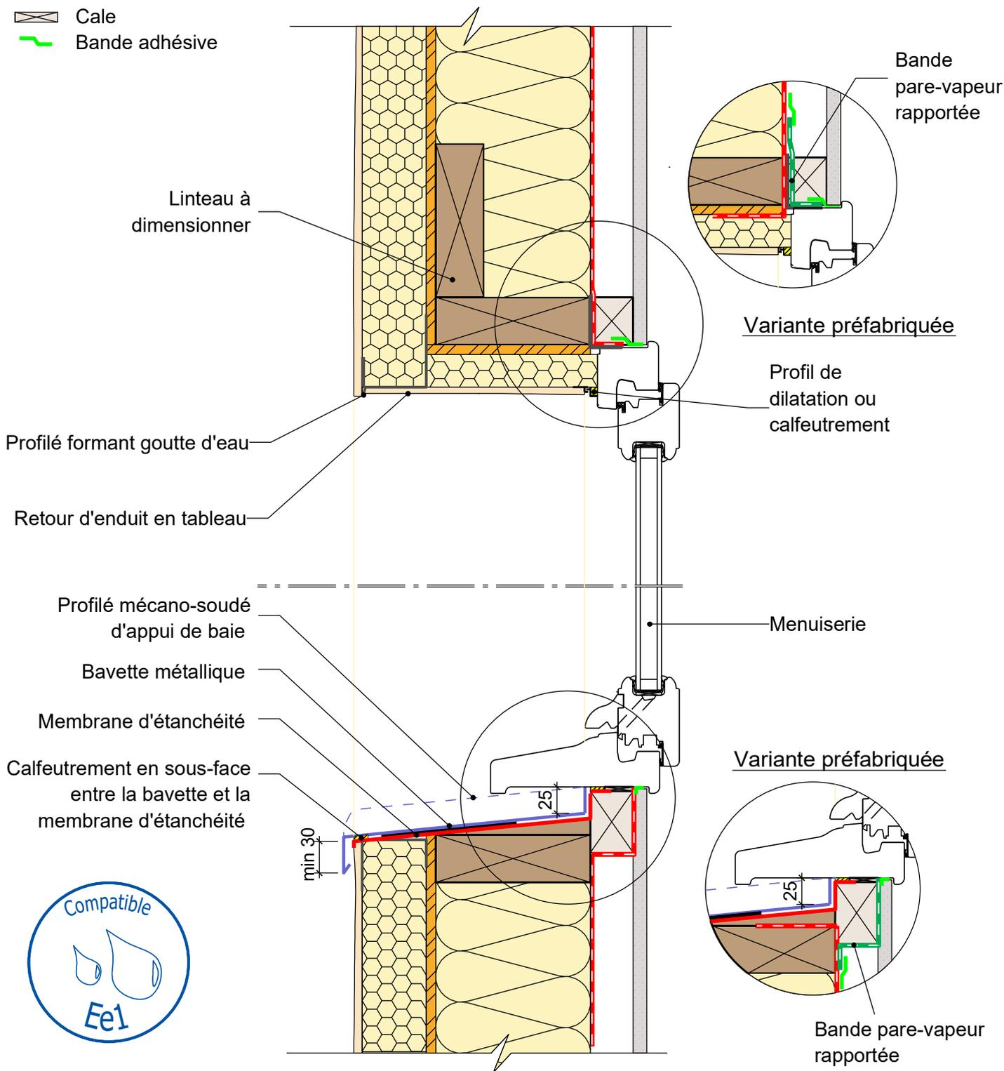
**MUR EXTERIEUR TYPE 7: Isolant en âme et ITE avec finition enduit**
