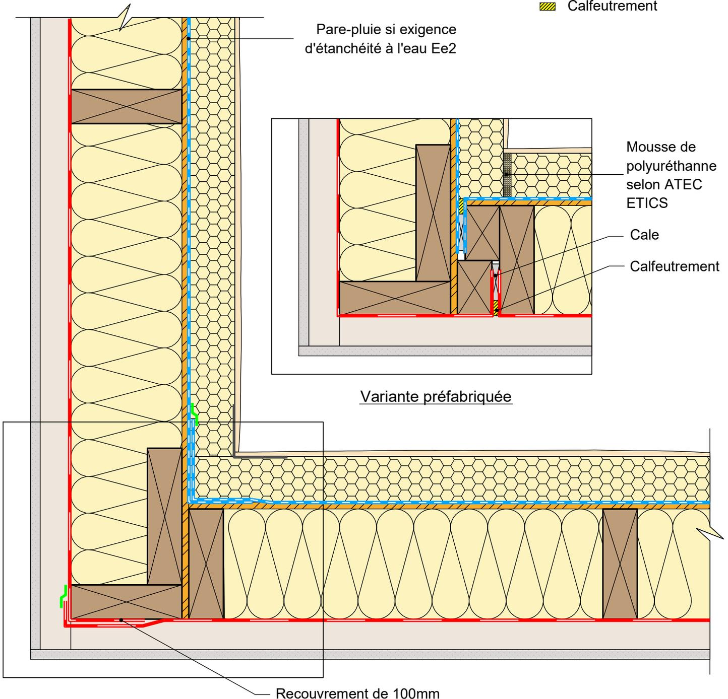
**MUR EXTERIEUR TYPE 7: Isolant en âme et ITE avec finition enduit**
