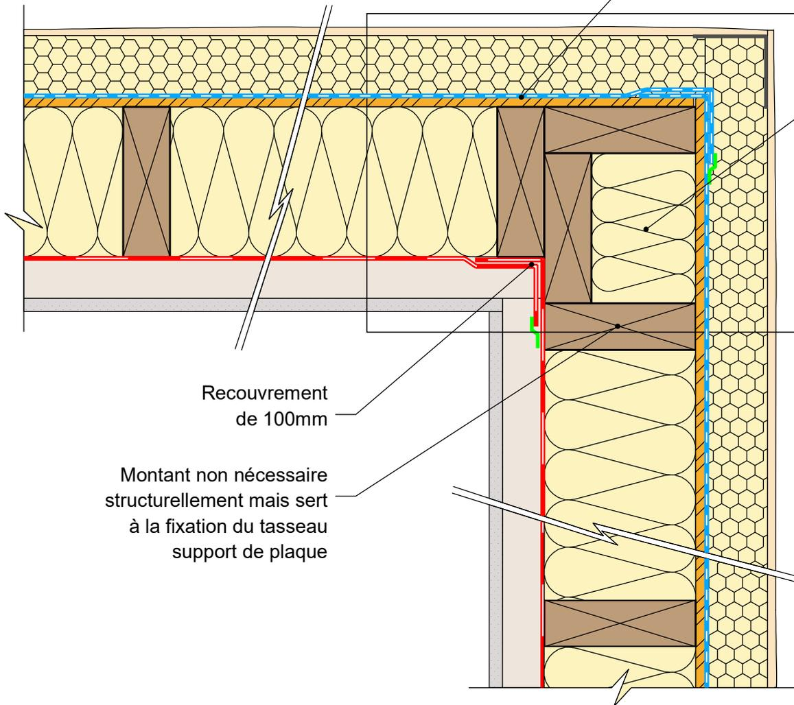
Recouvrement de 100mm
