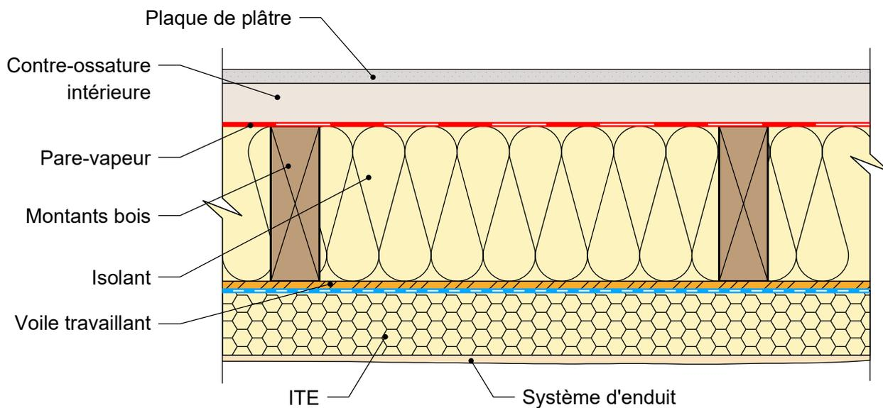
**MUR EXTERIEUR TYPE 7: Isolant en âme et ITE avec finition enduit**
