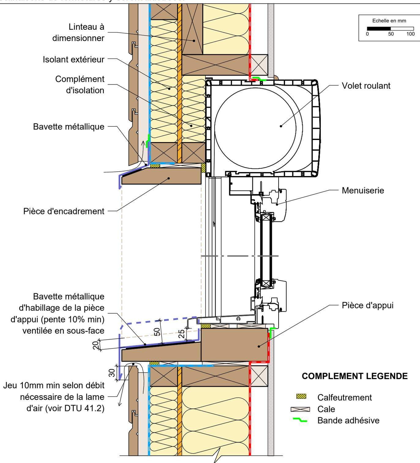
**MUR EXTERIEUR TYPE 6: Isolant en âme et en doublage extérieur**
