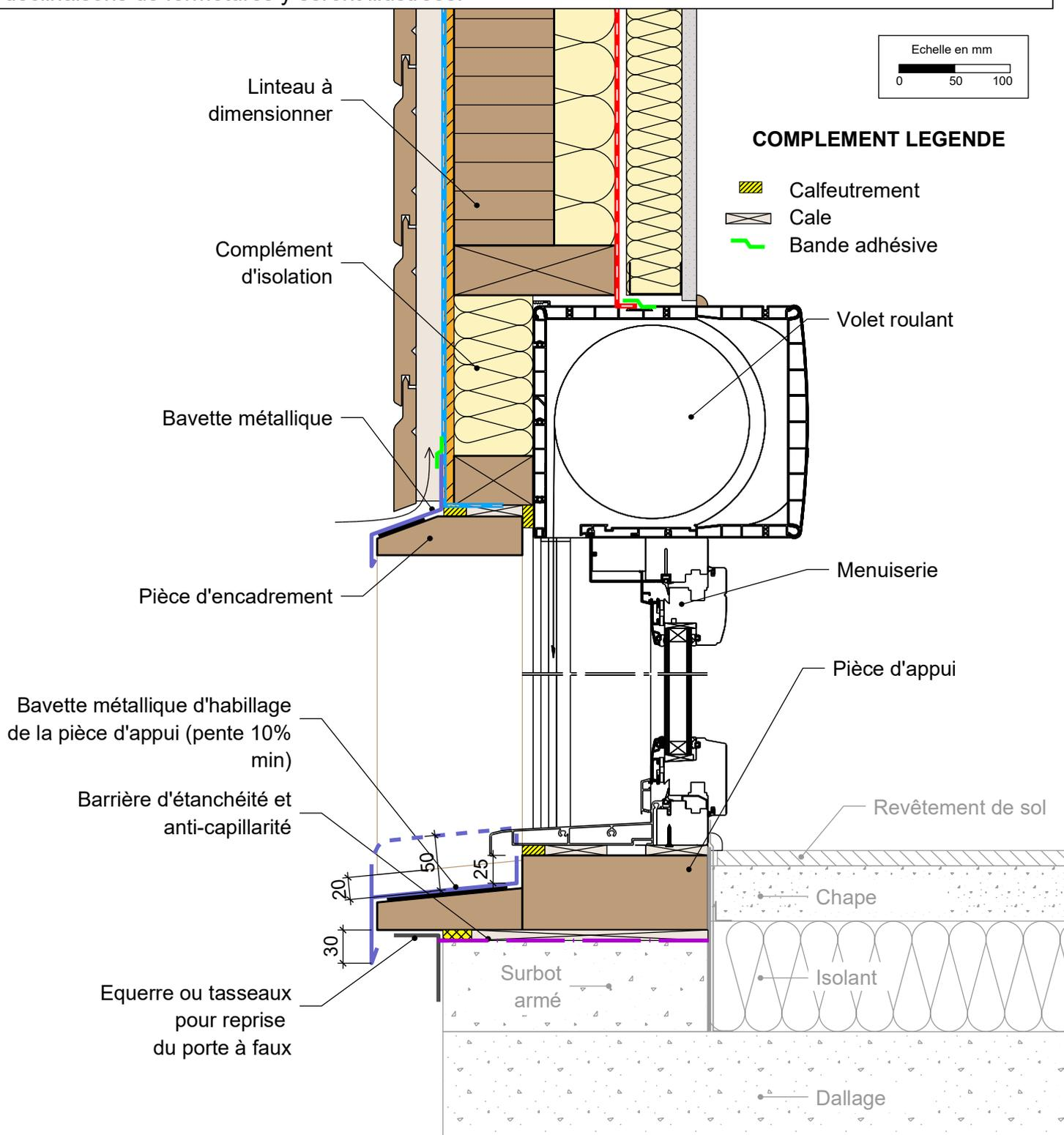
**MUR EXTERIEUR TYPE 5: Isolant en âme et contre-cloison isolée à ossature métallique**
