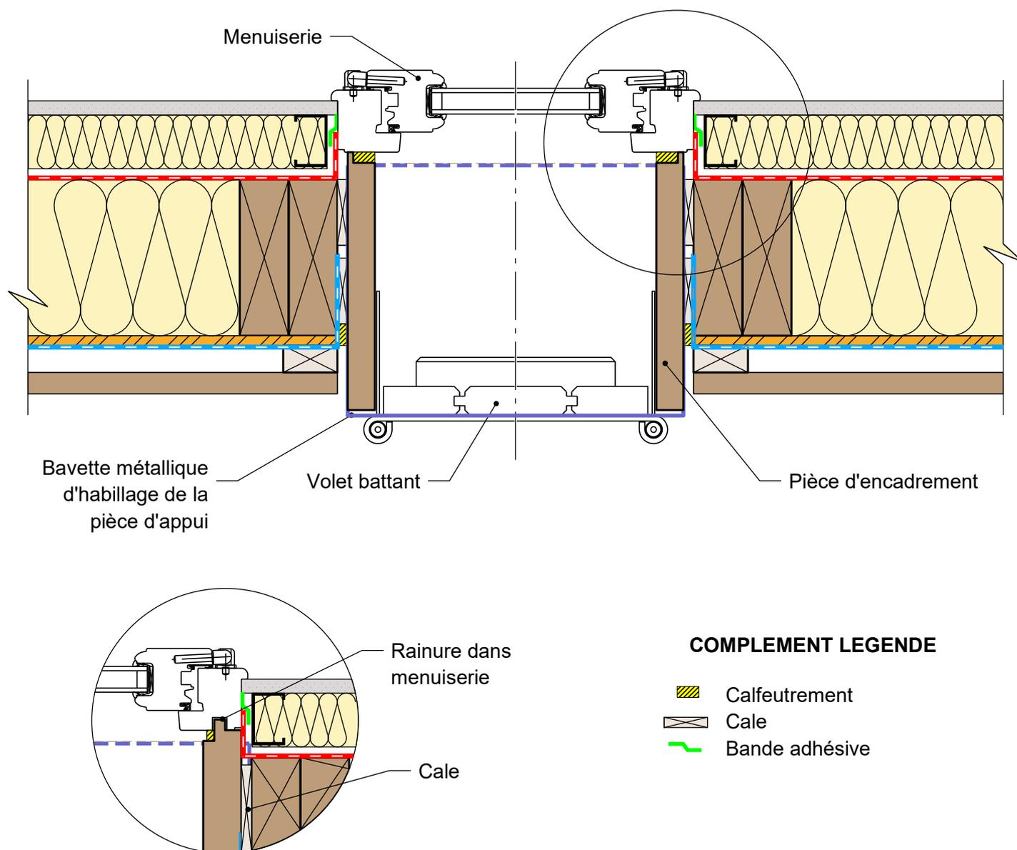
**MUR EXTERIEUR TYPE 5: Isolant en âme et contre-cloison isolée à ossature métallique**
