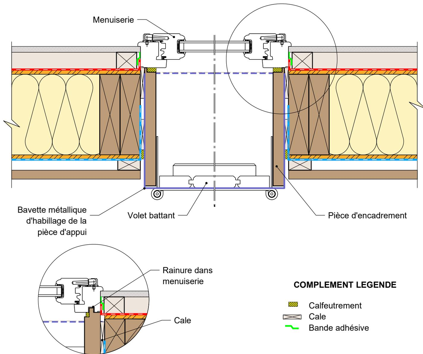
**MUR EXTERIEUR TYPE 3: Isolant en âme - voile travaillant intérieur et extérieur**
