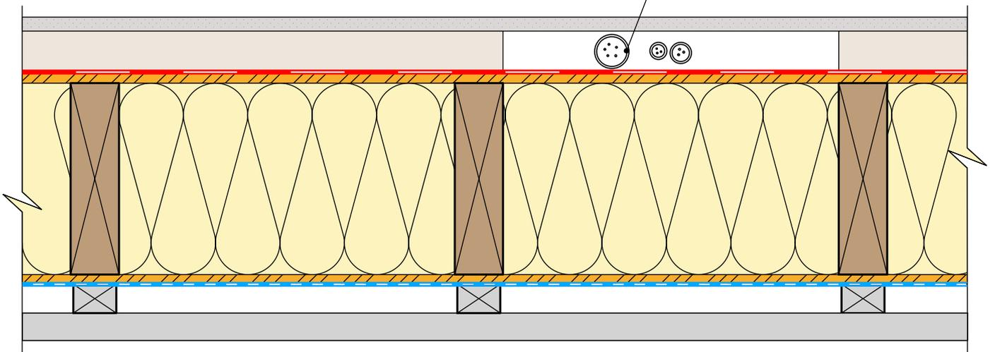
**MUR EXTERIEUR TYPE 3: Isolant en âme - voile travaillant intérieur et extérieur**
