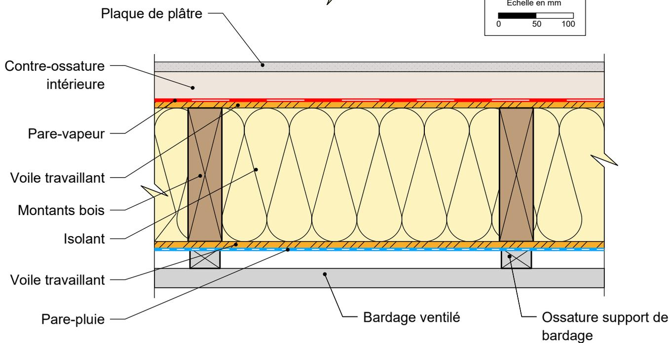
**MUR EXTERIEUR TYPE 3: Isolant en âme - voile travaillant intérieur et extérieur**
