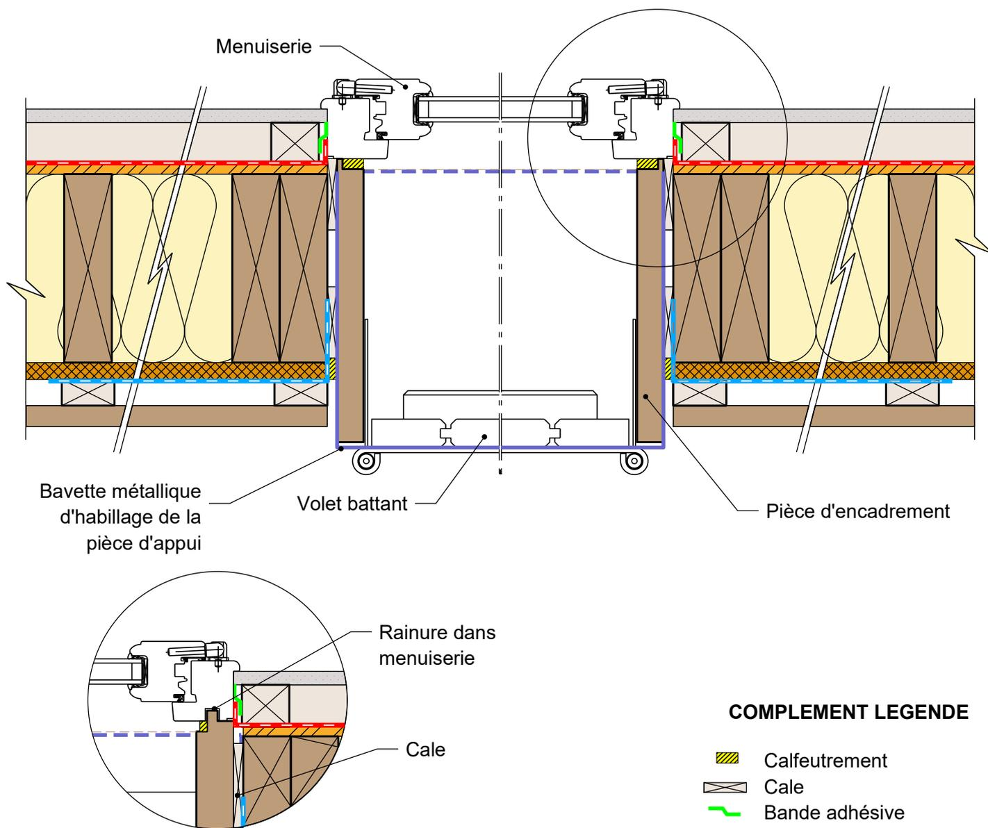
**MUR EXTERIEUR TYPE 2: Isolant en âme - voile travaillant intérieur**
