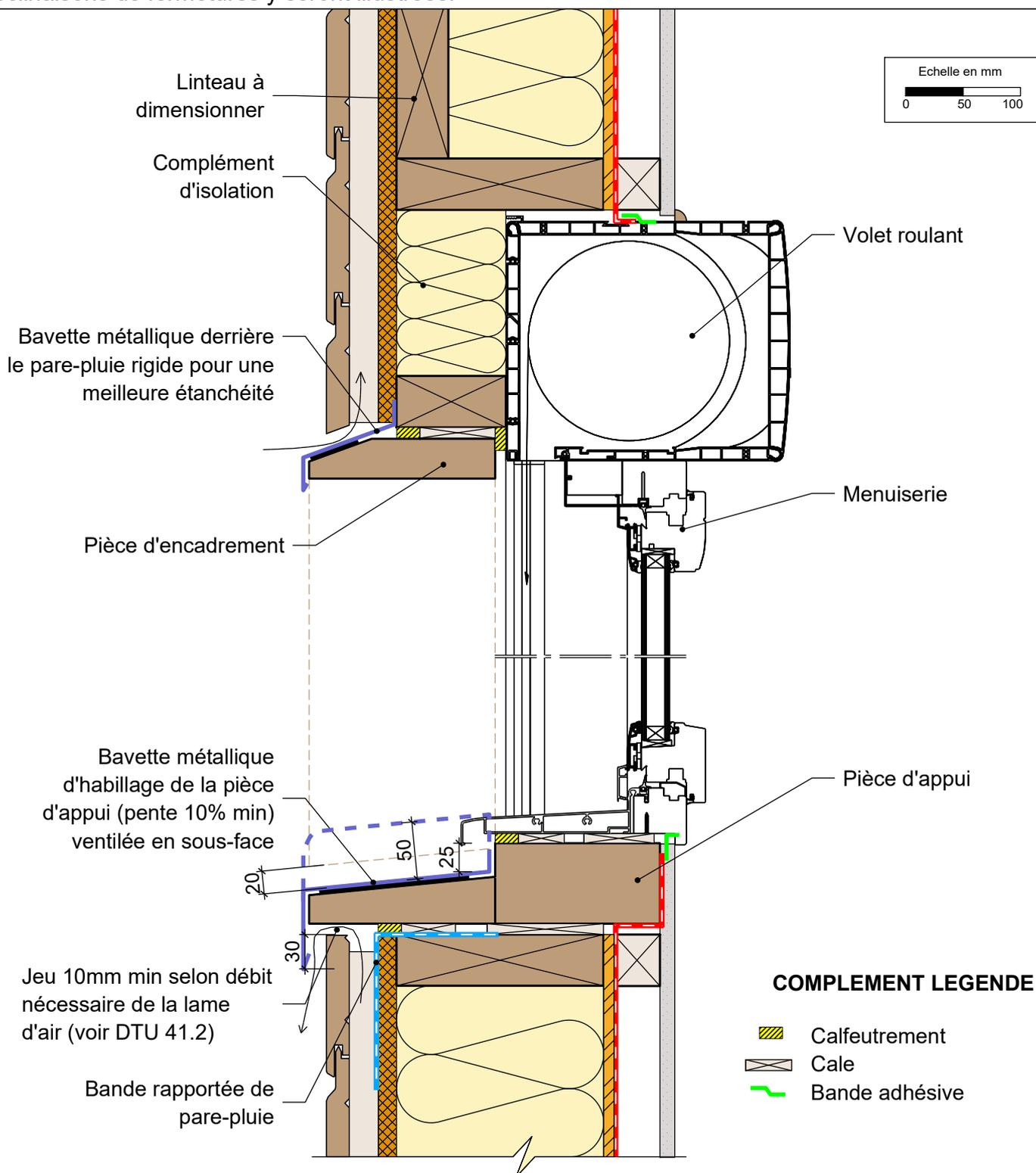
**MUR EXTERIEUR TYPE 2: Isolant en âme - voile travaillant intérieur**
