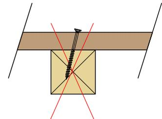
Nota : Quel que soit le type de vis, elles doivent être mises en oeuvre verticales, perpendiculaires au plan de l'appui entre la lame et le support.
