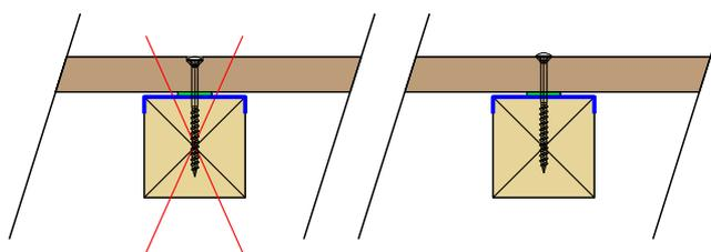
Nota : Quel que soit le type de vis, elles doivent être mises en oeuvre verticales, perpendiculaires au plan de l'appui entre la lame et le support.
