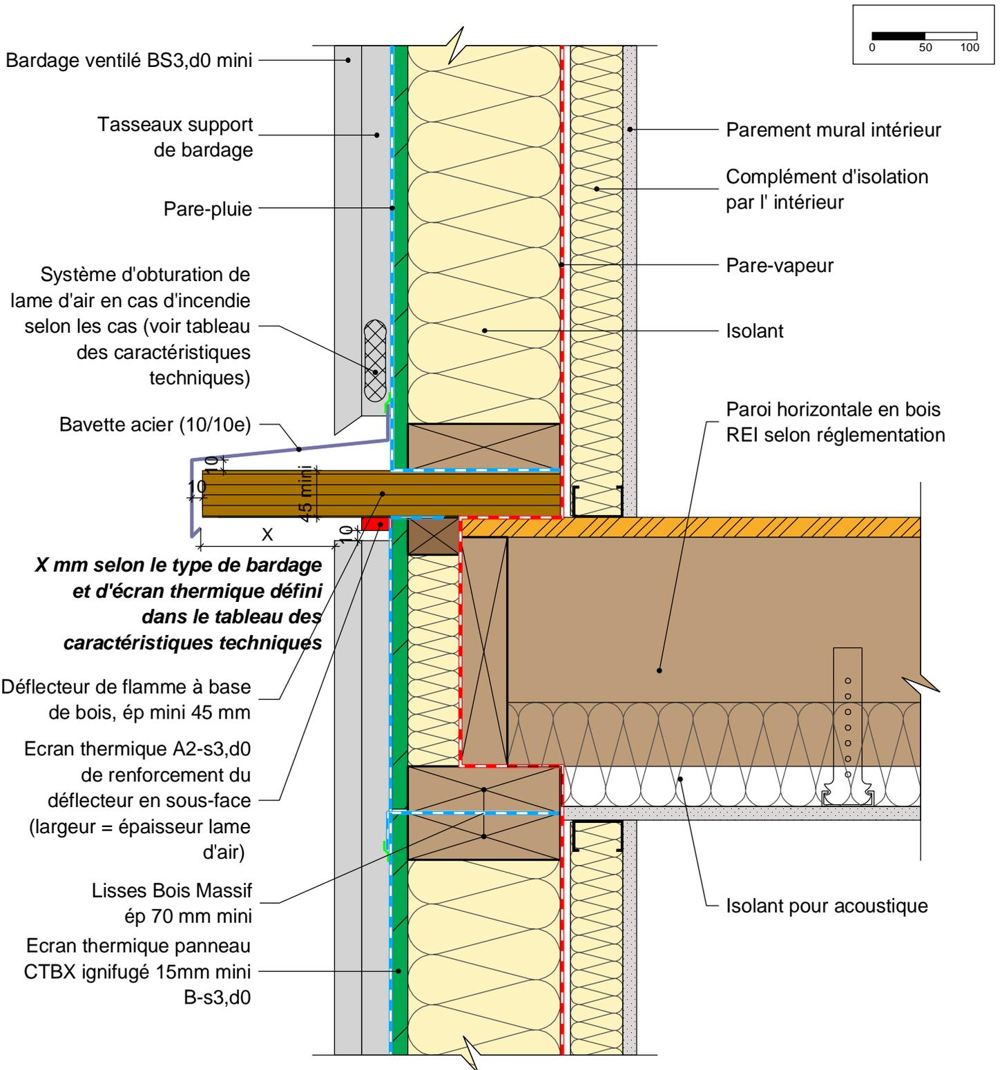
**X mm selon le type de bardage et d'écran thermique défini dans le tableau des caractéristiques techniques**
