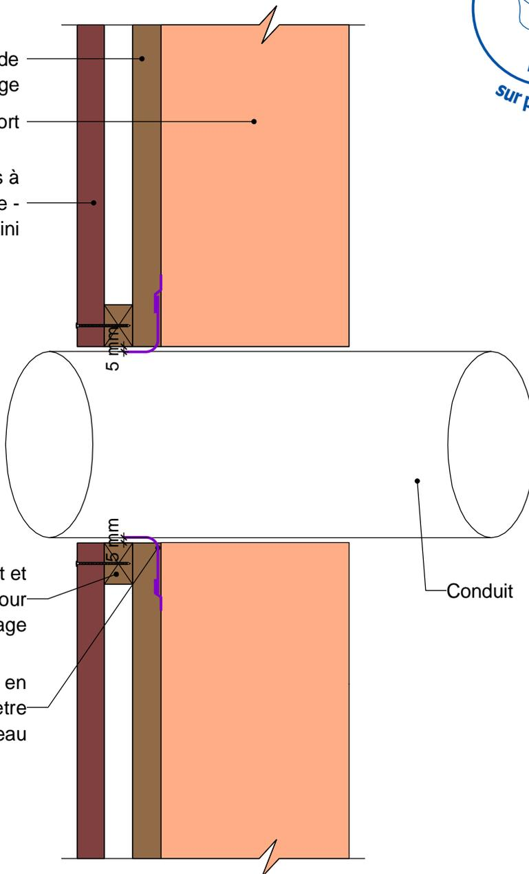
Tasseaux à prévoir de part et d'autre du percement pour fixation des lames de bardage
