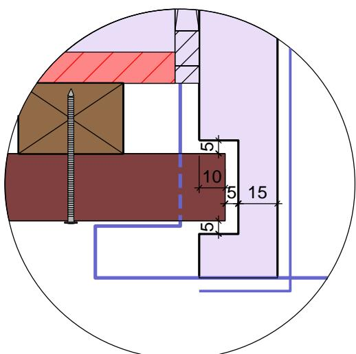
Pièce d'encadrement en matériau Euroclasse B-s3,d0 (ép 25 mm minimum + habillage acier(10/10e) avec jeu de 5 mm entre capotage et la pièce d'encadrement
