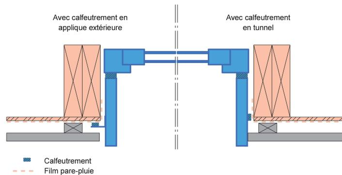
Figure 3 : Cas d'une menuiserie avec encadrement de baie intégré
