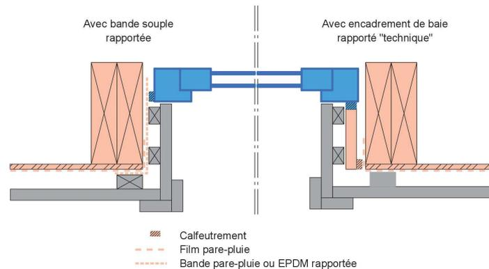
**Figure 4 : Cas d'un retour de bardage en tableau**
