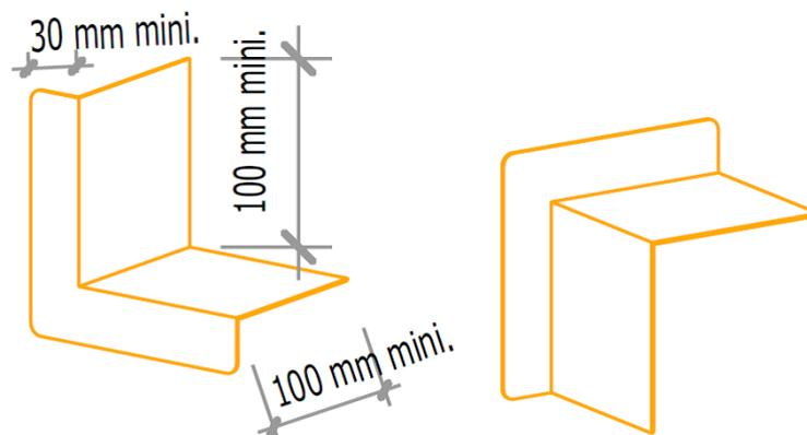
**Figure 1 : dimensions minimales des angles préformés**
