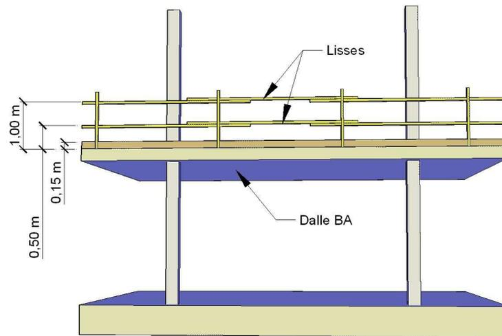
Figure 1 : Mise en place de garde-corps en retrait des nez de dalle
