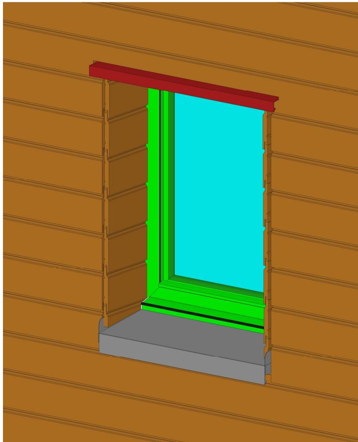
Figure 33 : Pose des lames de bardage sur la paroi et dans le tableau
