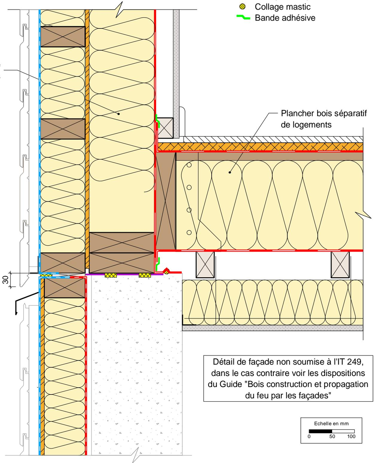
Détail de façade non soumise à l'IT 249, dans le cas contraire voir les dispositions du Guide "Bois construction et propagation du feu par les façades"
